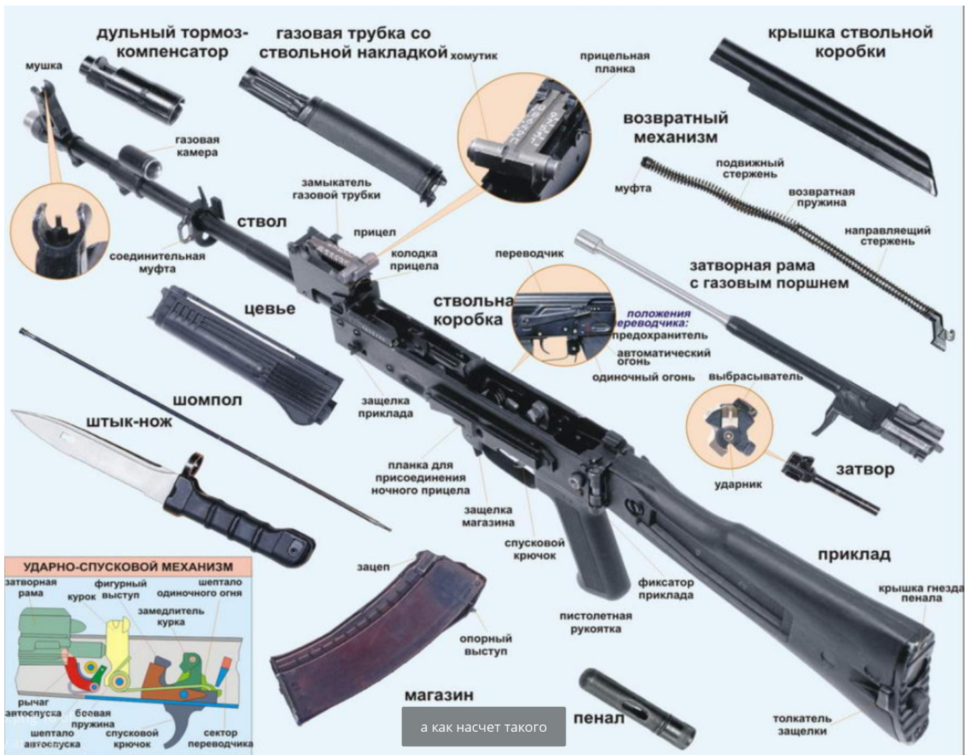
Рис. 2 – Устройство автомата Калашникова.
