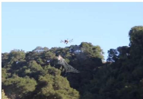
20.1: Накрытие БЛА сетью при перехвате [18]
