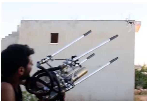
21.1: Накрытие БЛА сетью при перехвате с земли [13]
