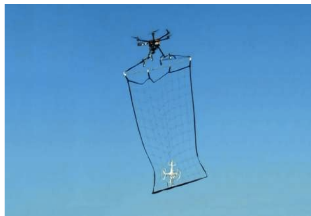
20.2: Подхват БЛА сетью при перехвате [6]
