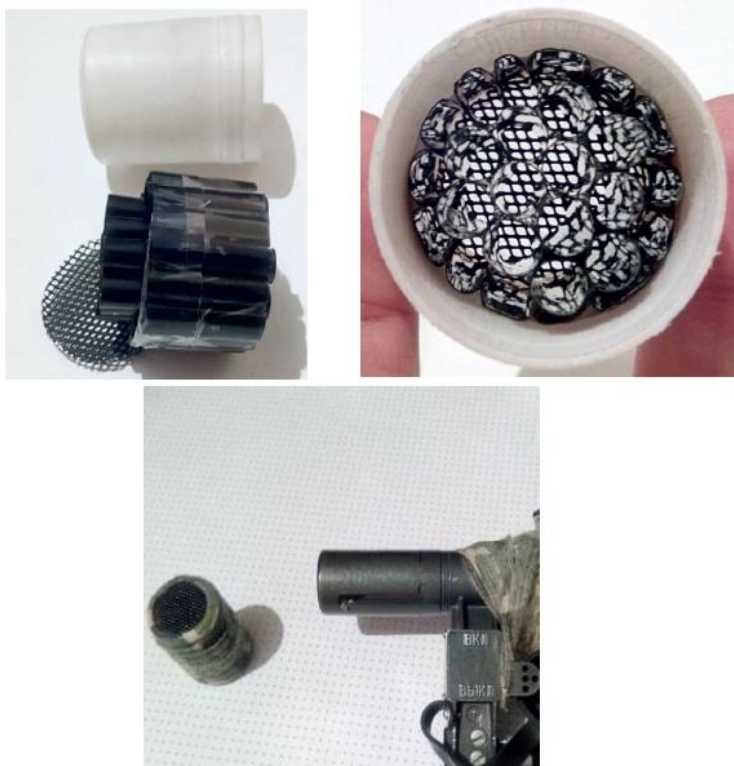
Рис. 3.6 – вариант самодельной сотовой бленды-насадки к ПСО-1 по опыту проведения ООС (ранее АТО).
