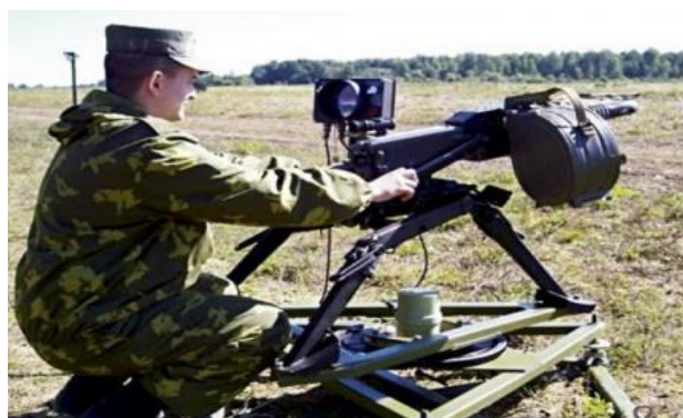
Рис. П3.4 – комплекс сообщения системы обнаружения и поражения. Состоит из универсальной платформы с АГС-17 и информационного табло.
