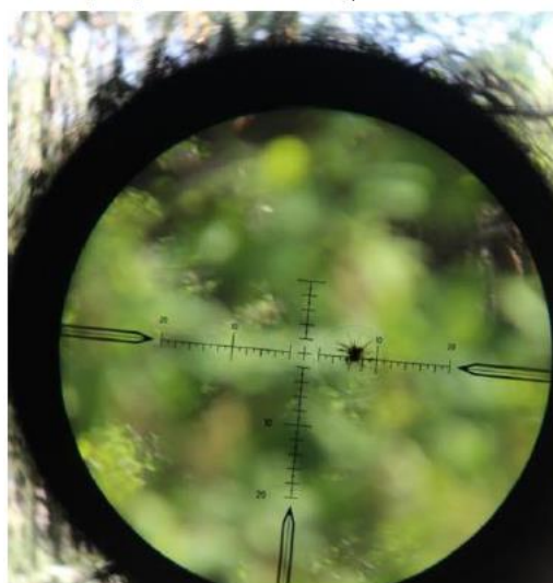
Рис. 3.2 – След на линзах оптического прицела от использования боевого ослепляющего лазера по опыту проведения ООС (ранее АТО).
