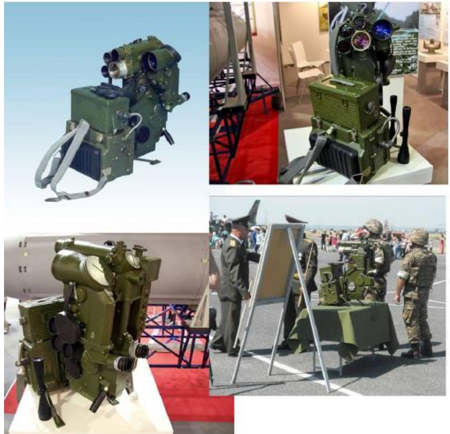
Рис. ПЗ.9 – переносной лазерный прибор оптико-электронного противодействия «ПАПВ».
