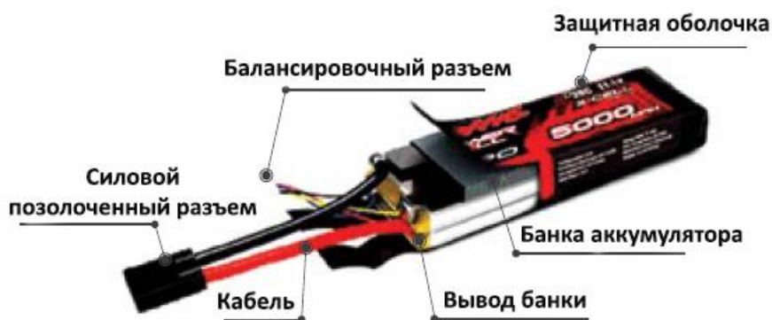
Рис.51. Устройство аккумулятора
