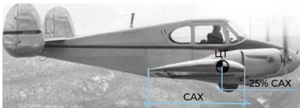
Рис.11. Схема САХ (средняя аэродинамическая хорда).
