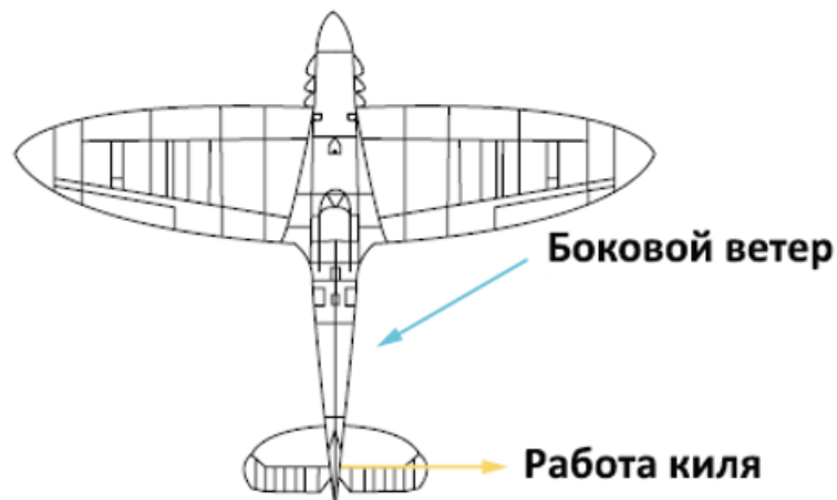
Рис.14. Курсовая устойчивость обеспечивается работой вертикального оперения (киля).
