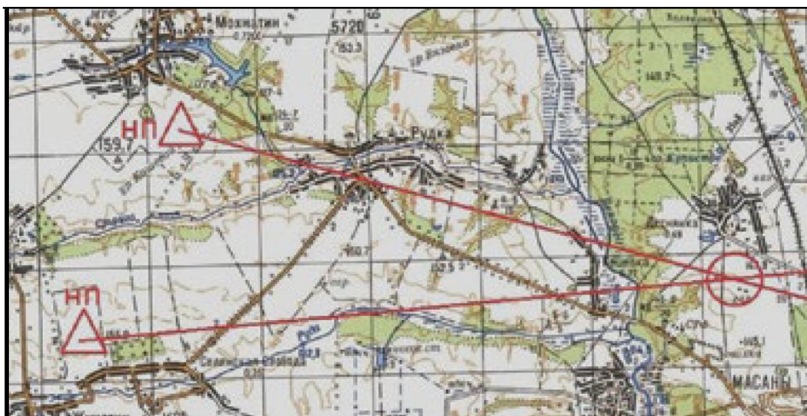
Рис.1. Определение цели по двум углам на неё.
