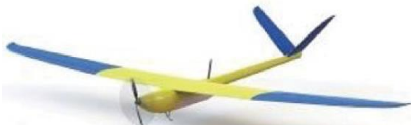
Рис.17. Классическая схема с тянущим винтом.
