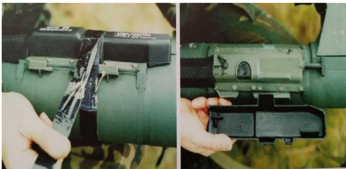
Рис. 20 — Контрольная лента на защитной крышке спускового механизма
