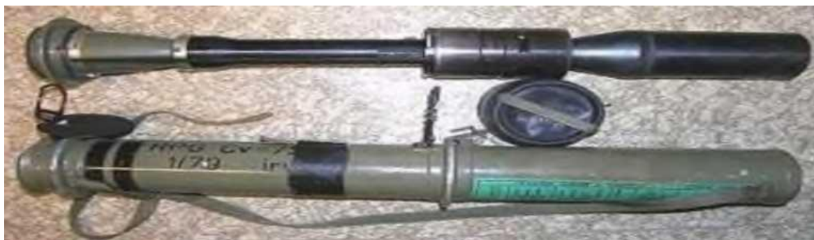
Рис. 6 — РПГ-Cv-75-тренировочная модель (для стрельбы по щитам)
