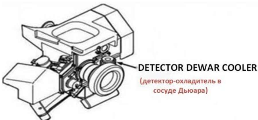
Рис. 89 — Тепловой детектор-охладитель (помещенный в сосуд Дьюара) (Detector Dewar Cooler)
