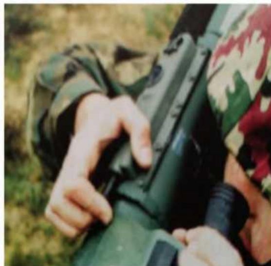
Рис. 23 — Нажатие рычага боевого взведения
