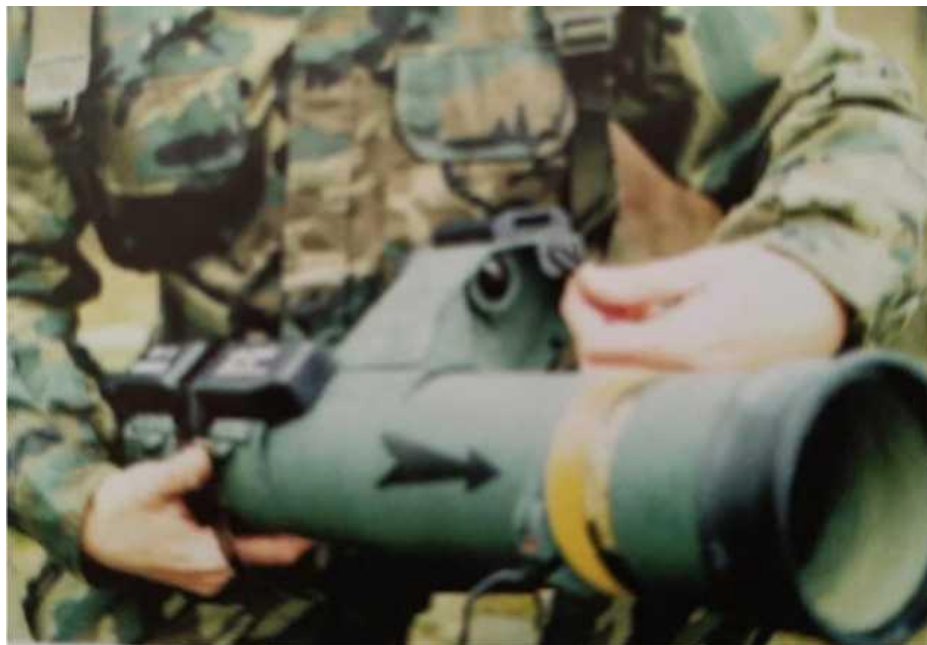
Рис. 19 — Снятие защиты и приведение в боевое положение оптического прицела
