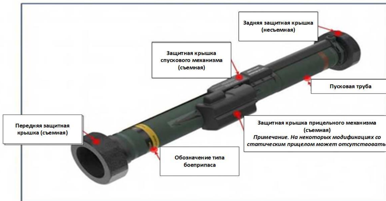
Рис. 14 — общий вид гранатомета C90-CR-AM (M3)
