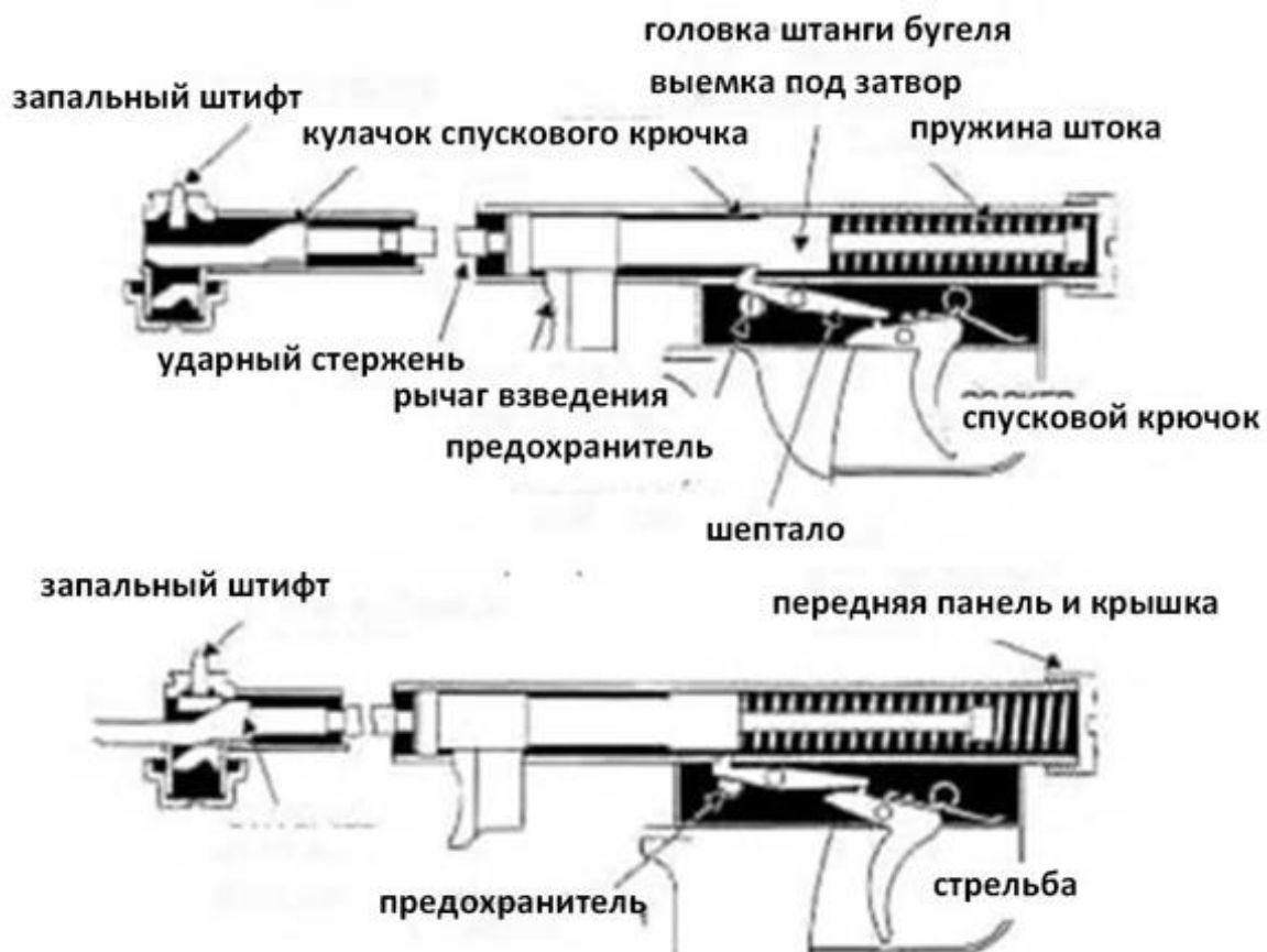
Рис. 54 — Основные механизмы гранатомета
