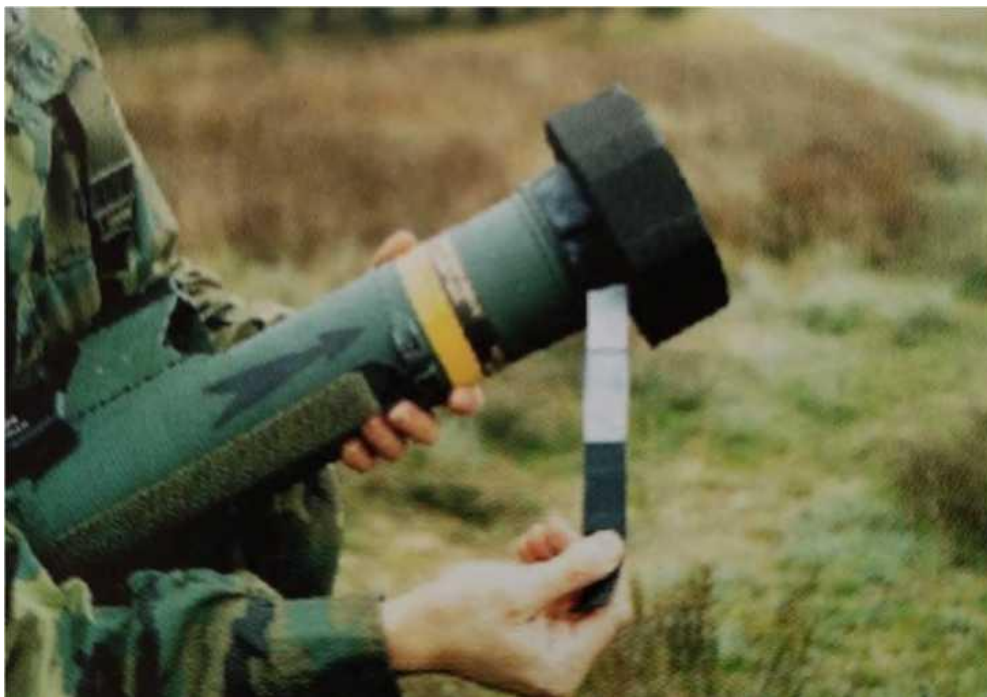
Рис. 16 — Снятие контрольной ленты
