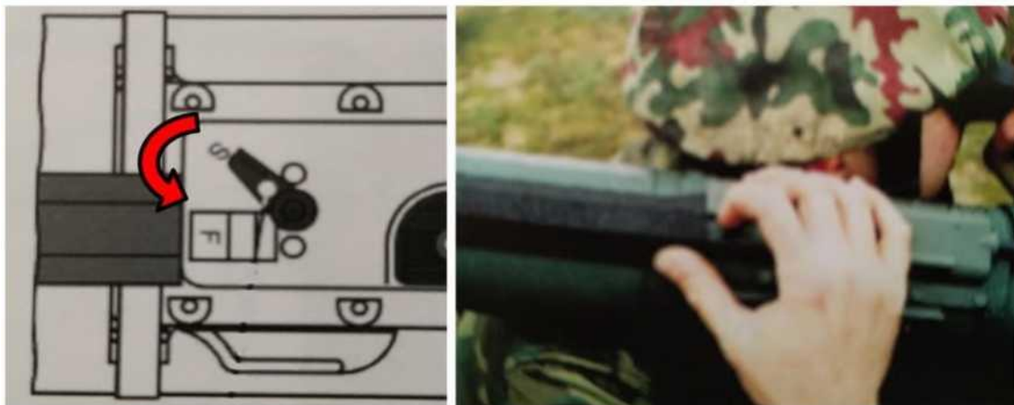
Рис. 25 — Положение переключателя предохранителя ("S")
