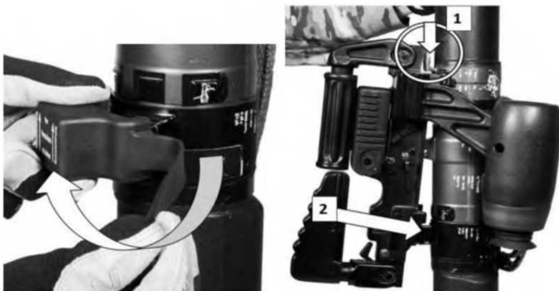
Рис. 66 — Снятие крышки воспламенителя и подсоединение инициатора
