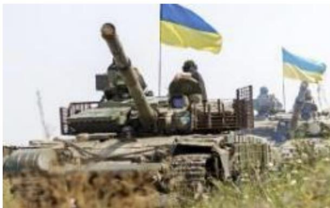
Вид танка, оборудованного противокумулятивными экранами
