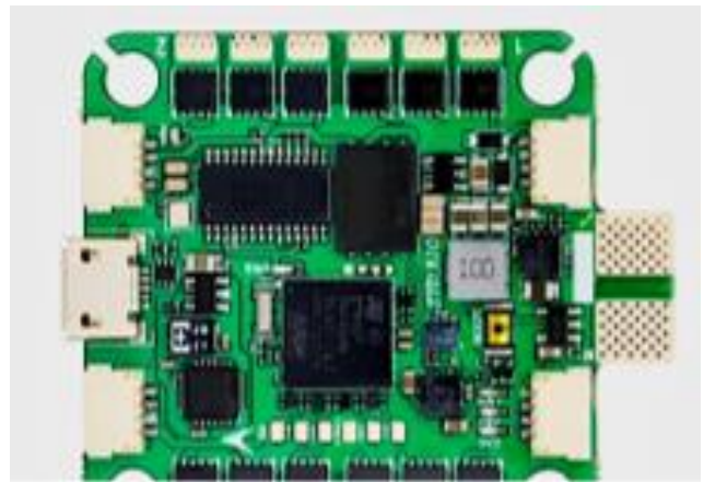
Рис. 5. – Полётный контроллер на базе процессора F745 с гироскопом MPU6000, барометром DPS310 и JSD AT7456E.
