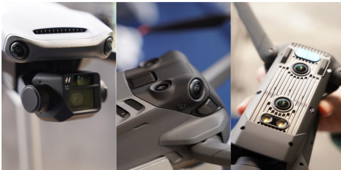
Рис. 10. – Датчики визуального контроля DJI Mavic 3.
