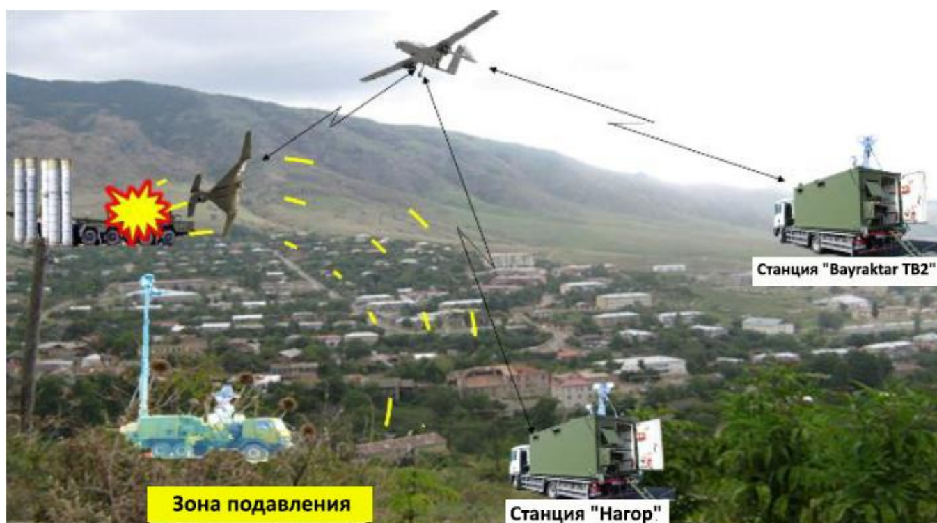
Рис. 12 – Вариант применения дронов-камикадзе при входе в зону подавления, когда каналы управления ретранслировались с наземной станции управления («Нагор») через БПЛА типа «Байрактар».
