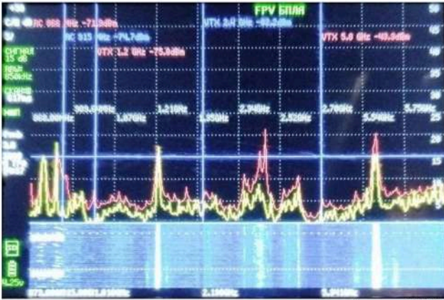
Де кілька FPV квадрокоптерів Керування та телеметрія: ППРЧ на частотах 868 МГц та 915 МГц Передача відео: аналогове відео в діапазоні 5,8 ГГц
