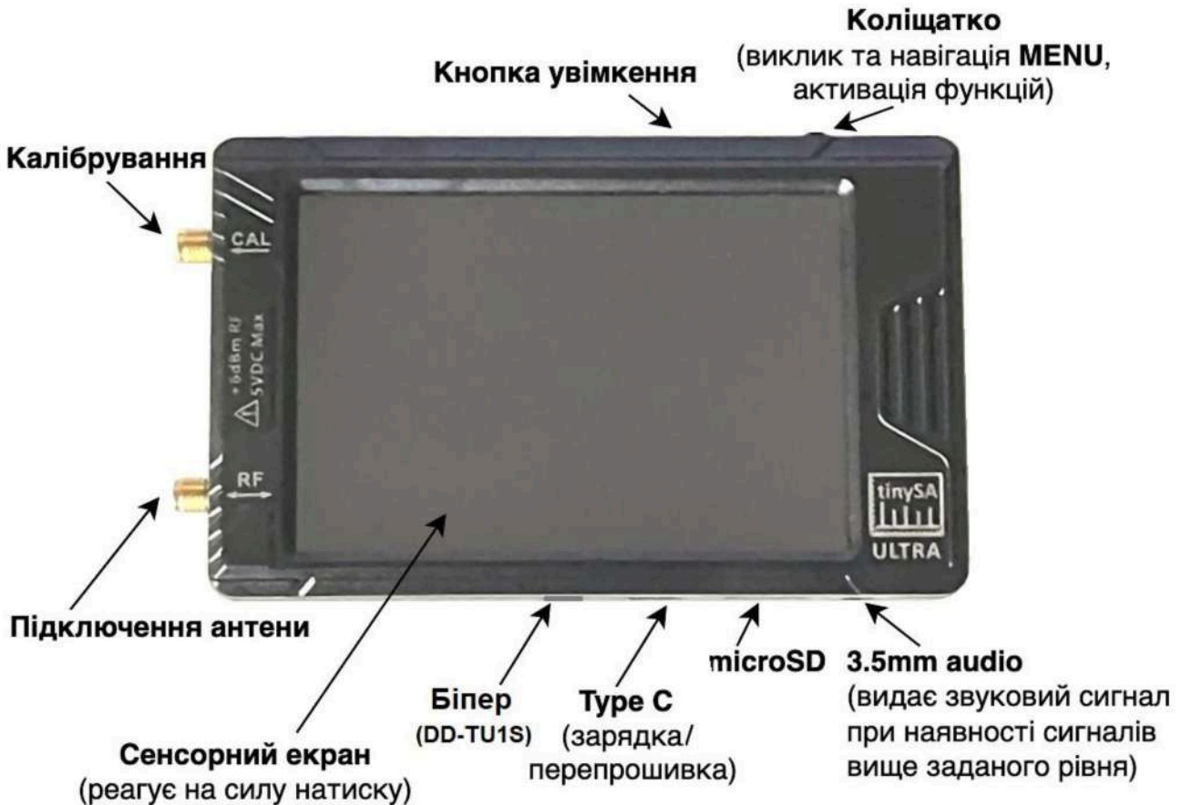
Органи керування аналізатора спектру tinySA Ultra
