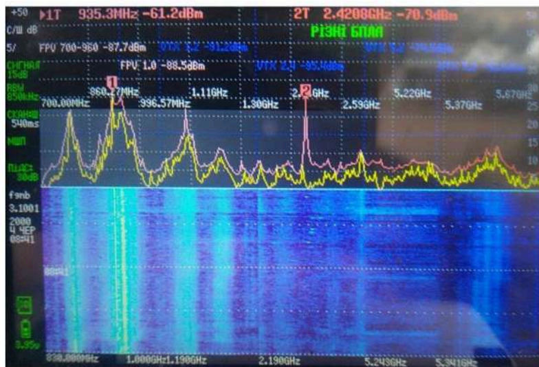
Де кілька FPV квадрокоптерів У діапазоні 5,8 ГГц можна побачити щонайменше шість смуг передачі відео
