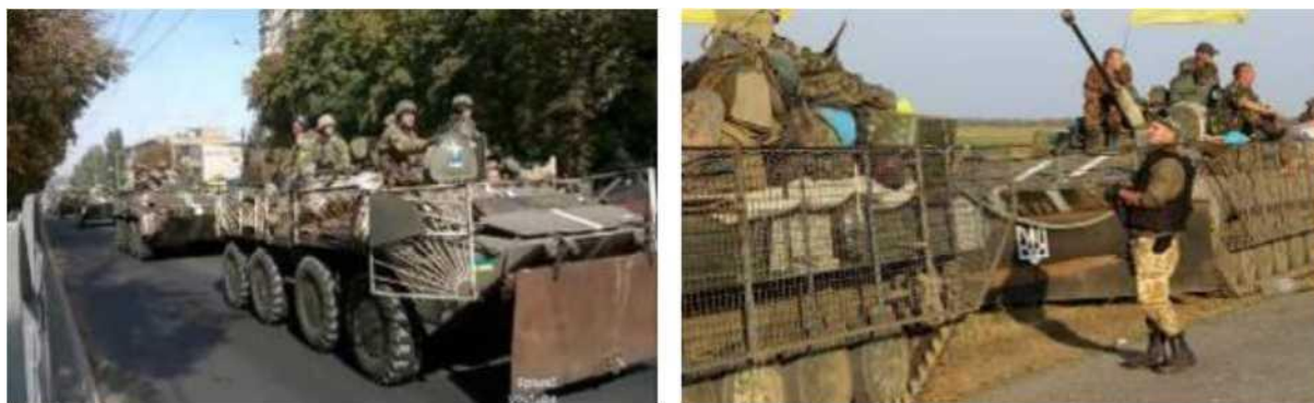
Рис. 7 – Повышение живучести бронированной техники.
