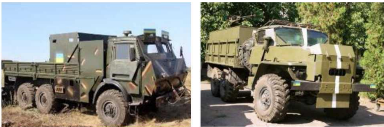
Рис. 3 – Примеры повышения живучести грузовых автомобилей и защиты личного состава в начале Антитеррористической операции на востоке Украины в 2014 году.
