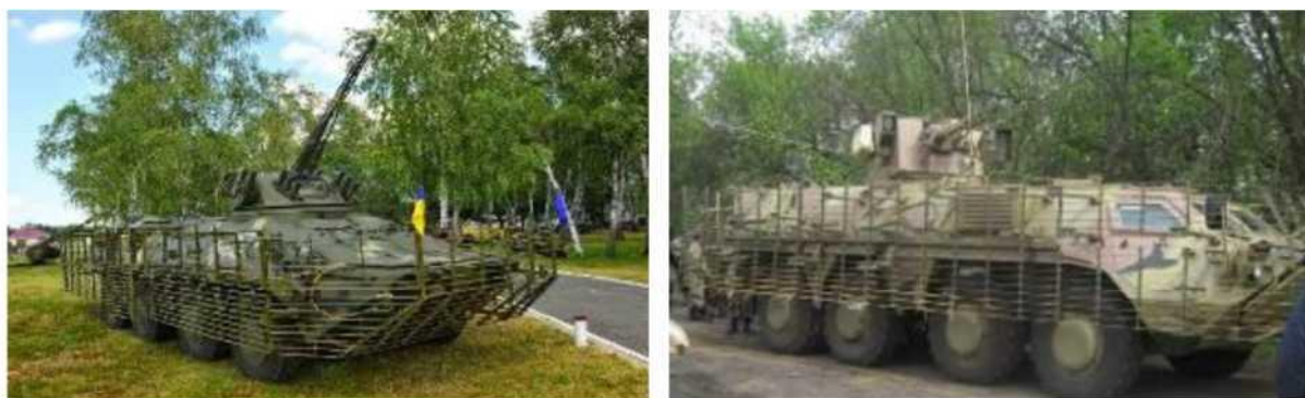
Рис. 8 – Принцип действия противокумулятивного экрана.
