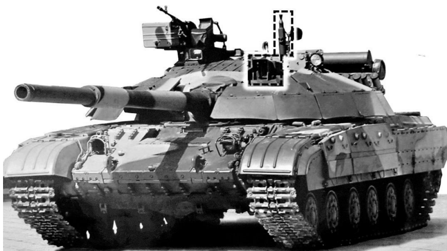
Рис. 26. – Танк Т-64БМ «Булат» с указанием расположения защитного колпака прицела и стойки датчика ветра.
