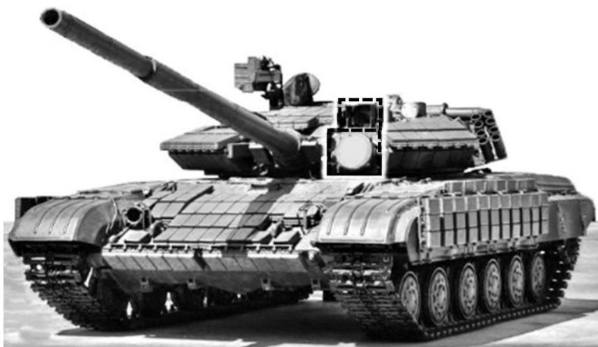
Рис. 25. – Танк Т-64БМ с указанием расположения инфракрасного прожектора и защитного колпака прицела.
