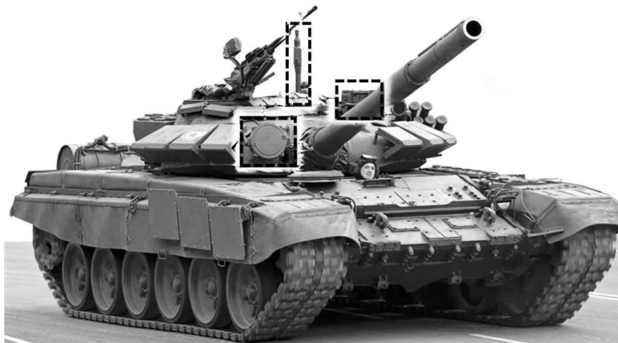
Рис. 21. – Танк Т-72БА с указанием расположения инфракрасного прожектора, защитного колпака прицела и стойки датчика ветра.
