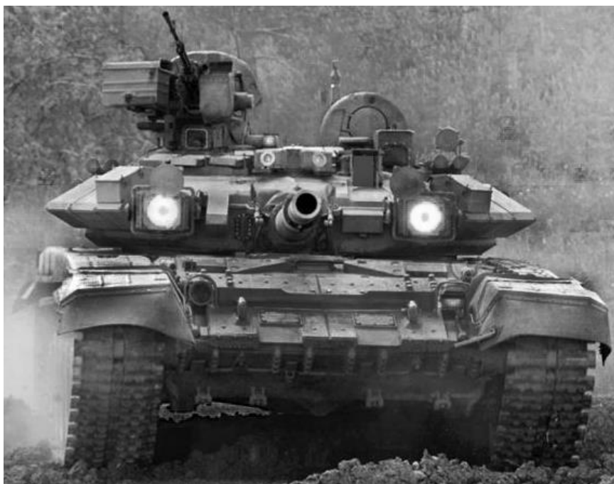
Рис. 24. – Танк Т-90 при применении комплекса «Штора».
