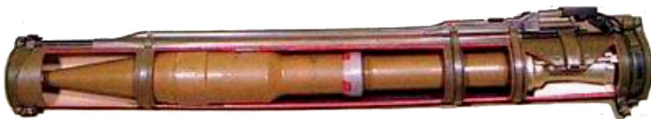
Рис. 3. – Общий вид размещения гранаты ПГ-18 в РПГ-18.
