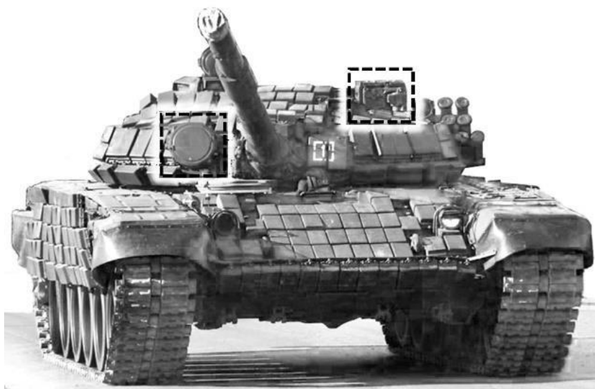
Рис. 20. – Танк Т-72Б с указанием расположения инфракрасного прожектора и защитного колпака прицела.
