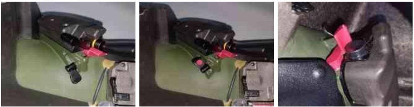
Транспортный предохранитель в позиции «Безопасно» (фото слева) и в боевой позиции (фото в центре). На фото слева и в центре на пусковой кнопке видно оранжевую полоску. На фото справа кнопка утоплена, оранжевую полоску не видно.
