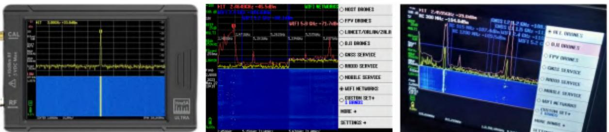
Рисунок 3 – Анализатор спектра «tinySA Ultra» со специальной прошивкой «РЭР БЛА v2.5.2a»
