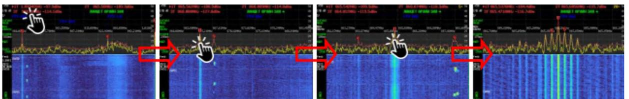
Рисунок 36 – Пример ручного масштабирования сигнала с центральной частотой 866 МГц
