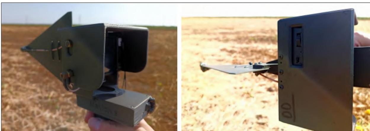
Рисунок 28 – Вертикальная поляризация антенны (слева) и горизонтальная поляризация антенны (справа)
