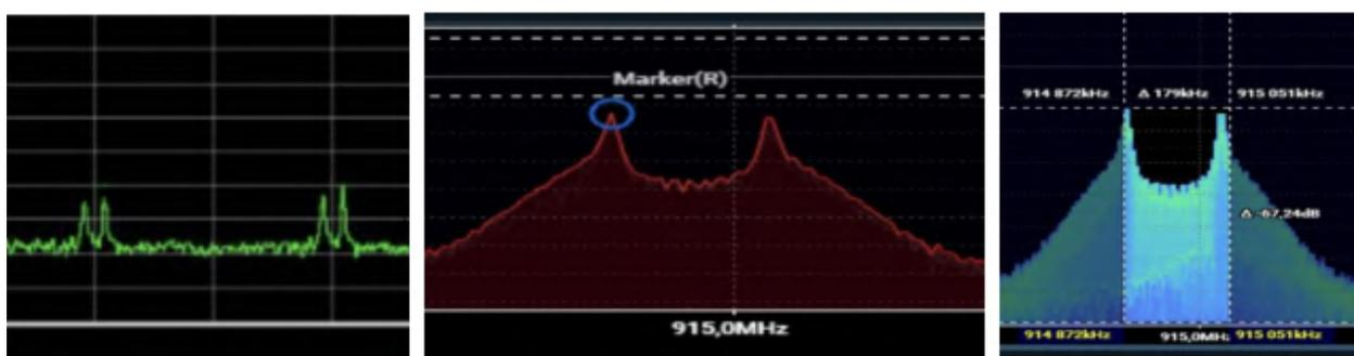
Рисунок 49 – БЛА «Ланцет» и ZALA-421 (частоты 860÷870 МГц, 902÷928 МГц)
