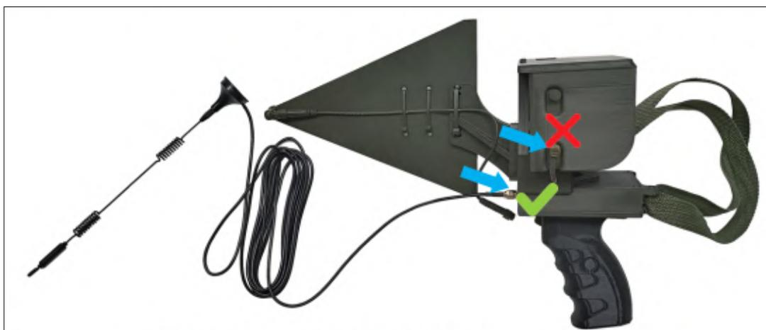
Рисунок 40 – Подключение выносной антенны к БЛА-детектору
