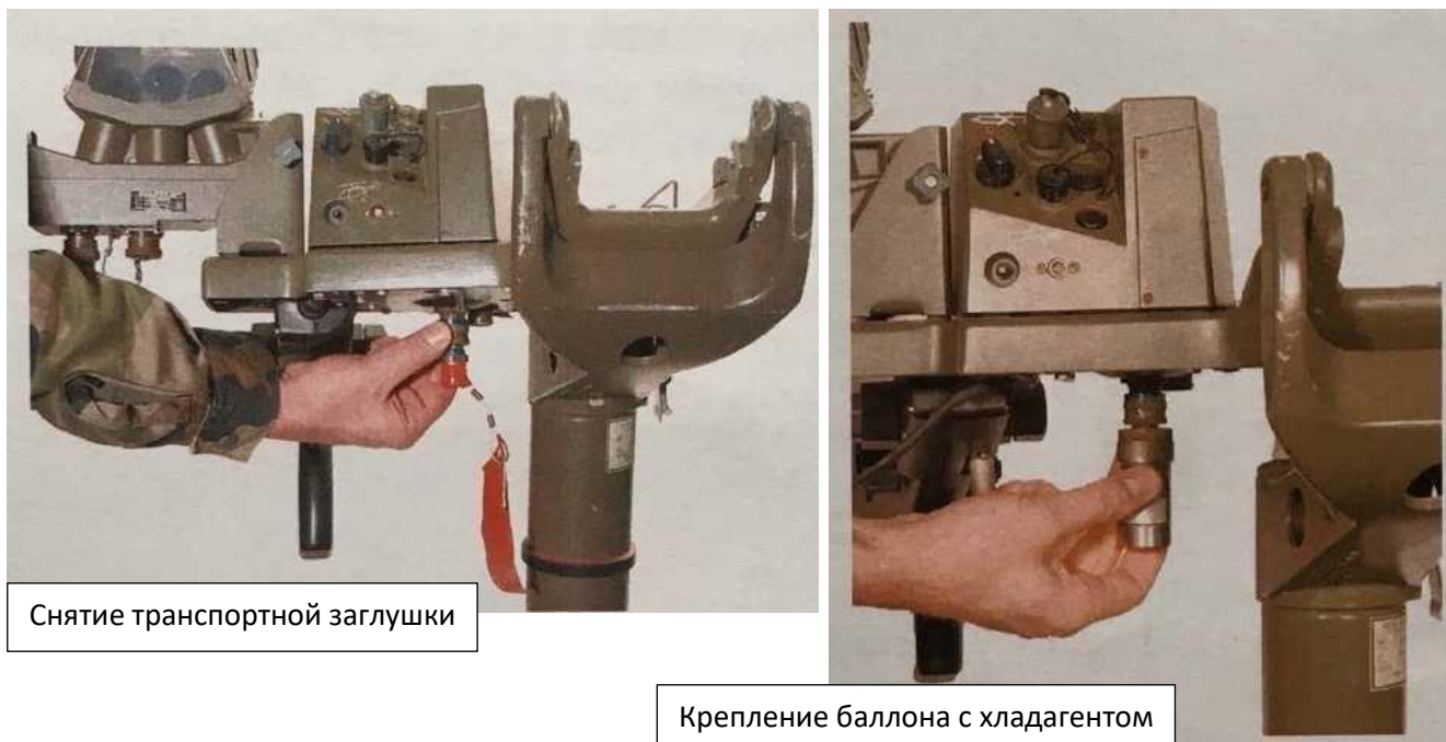
Рисунок 2.2.5. – Работа с прицельным приспособлением ПЗРК “MISTRAL”
