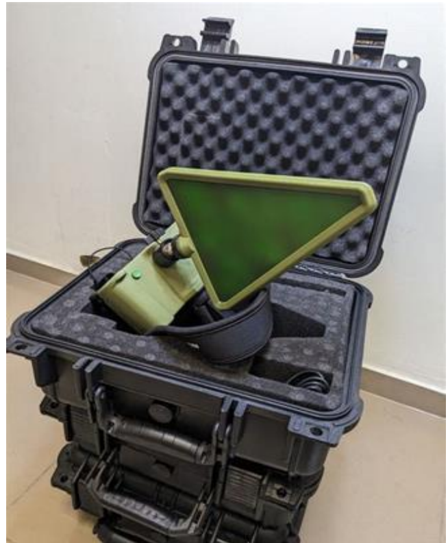
Р и с. 3. Детектор дронов Arrakis XM
