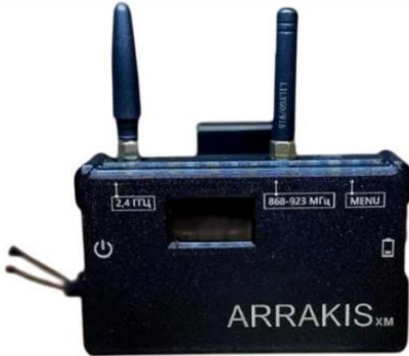
Р и с. 3. Детектор дронов Arrakis XM
